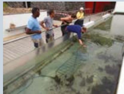
18 à 20. Un prototype de banc, une série d'objets tests ainsi qu'un abri à tortues ont été immergés en octobre 2016 dans les bassins de Kélonia à Saint-Leu sur l'île de la Réunion. C'est une nouvelle étape pour affiner les caractéristiques du dessin, le réglage du dispositif et valider l'intégralité de la chaîne de production.
