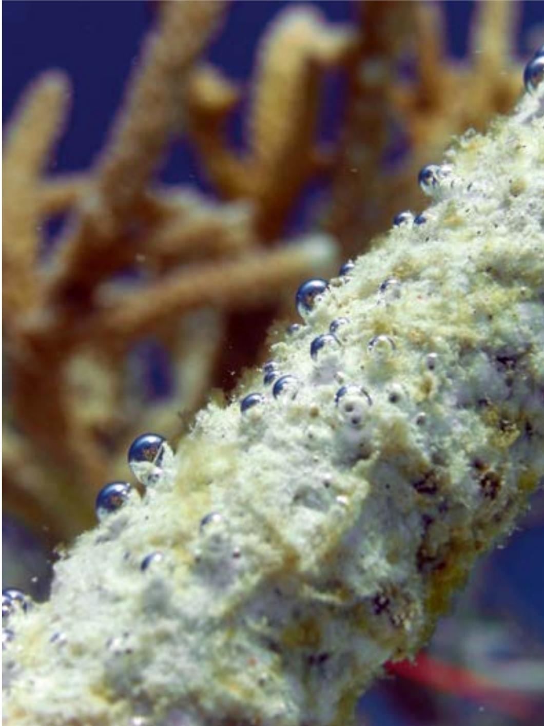
4. De petites bulles d'hydrogène se forment autour de la structure. Elles témoignent du bon fonctionnement du dispositif d'accrétion minérale.
